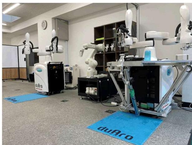
設置ロボット：小・中型汎用ロボット『RS007L』
