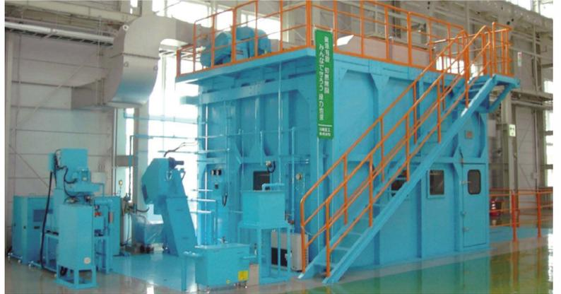
台車洗浄装置(ロボット洗浄方式)
