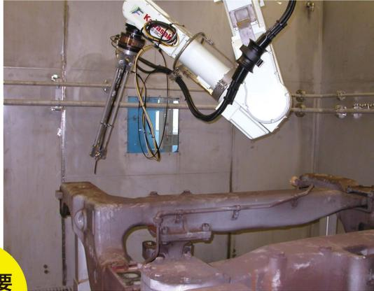
台車洗浄ロボット(ロボット洗浄方式)
