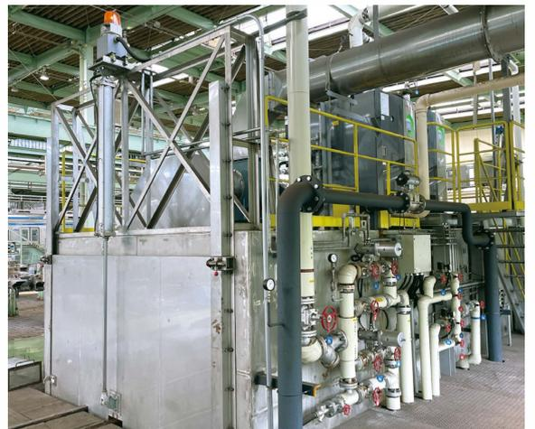
台車洗浄装置(噴射洗浄方式)
