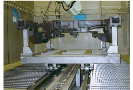
洗浄ブース内(ロボット洗浄方式)
